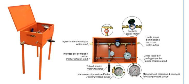
I principali strumenti necessari per l'esecuzione della prova Lugeon sono contenuti all'interno di una cassetta di semplice utilizzo. Basta infatti eseguire le seguenti operazioni:
